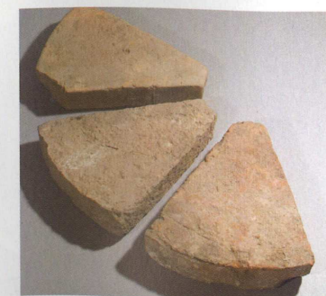
上: マウロ・ゾッケッタの「ヴィラ・ゲーム」のためのスケッチ。下: パラッツォ・キエリカーティの柱に使用された、扇状の型から作成した煉瓦。
